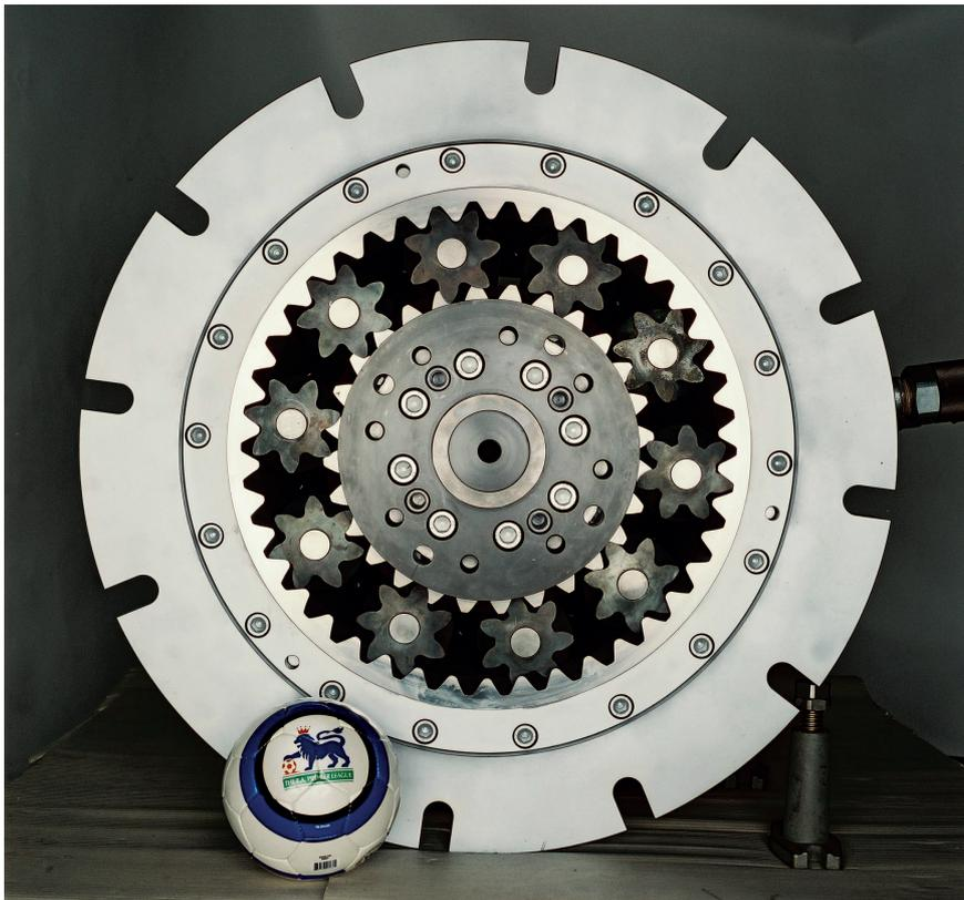
Die Direktextrusion von PVC-Profilen auf Planetwalzenextrudern kann Kosten und Energie einsparen und den Prozess vereinfachen © Entex
